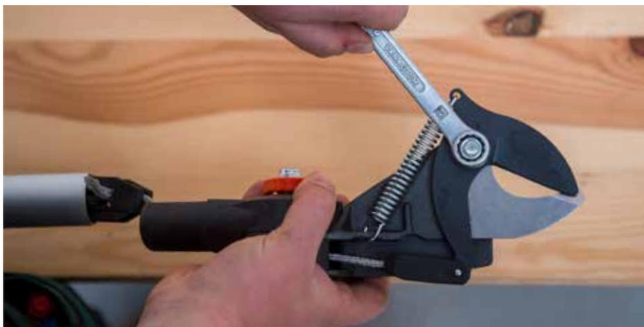
24 Rimettere la testa nel tubo. ATTENZIONE: controllare che la data di produzione sul carrello sia girato sullo stesso lato del logo Stocker.
